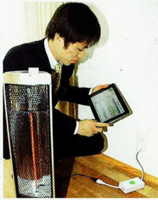
電力使用量をHEMSで確認できるスマートハウス。発電、蓄電情報を組み合わせたエネルギー管理が期待されている。松山市
